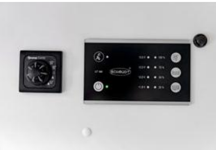
Panneau de contrôle avec indicateurs des niveaux de remplissage et de charge de la batterie
