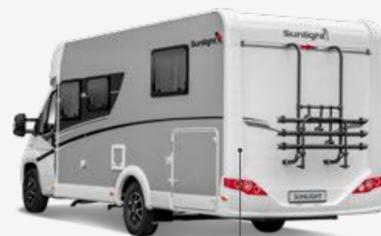
Pare-chocs arrière avec parties thermoformées montantes
